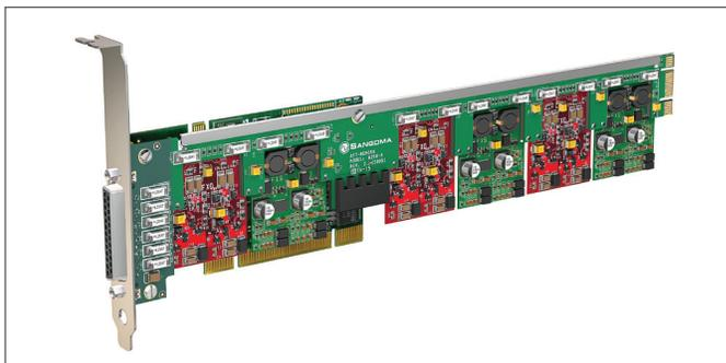
La A400 se compone de una tarjeta auxiliar Remora™ montada en la tarjeta PCI AFT. La tarjeta Remora™ tiene seis zócalos, cada uno de los cuales admite un módulo FXO-2 o FXS-2. Cada módulo FXO-2 o FXS-2 admite dos líneas FXO o FXS, respectivamente.
