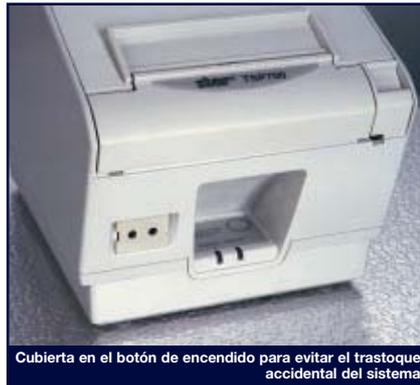
Cubierta en el botón de encendido para evitar el trastoque accidental del sistema
