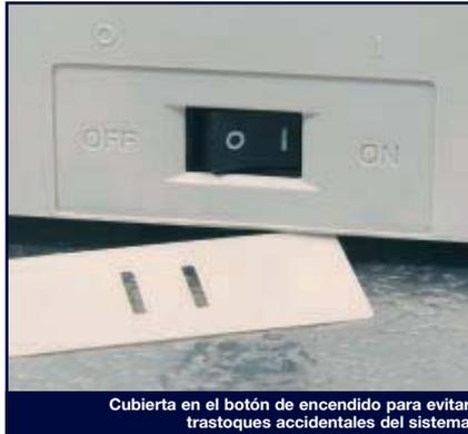
Cubierta en el botón de encendido para evitar trastoques accidentales del sistema
