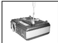
• Coloque los brazos del proyector (5) utilizando los tornillos (17)
